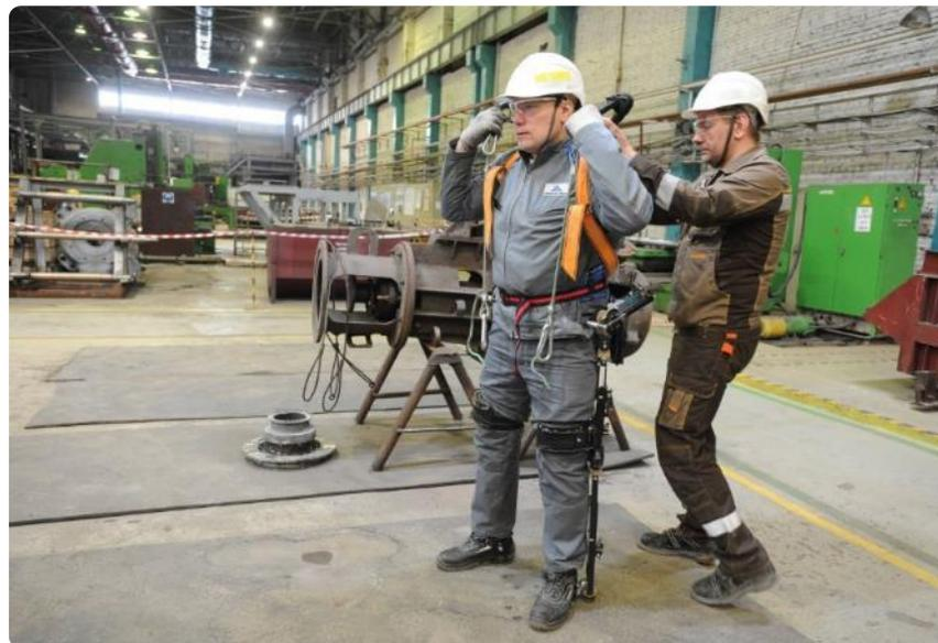
Применение промышленных экзоскелетов значительно снижает трудозатраты рабочих на погрузочно-разгрузочных работах. Пониженные нагрузки минимизируют риск получения производственных травм
